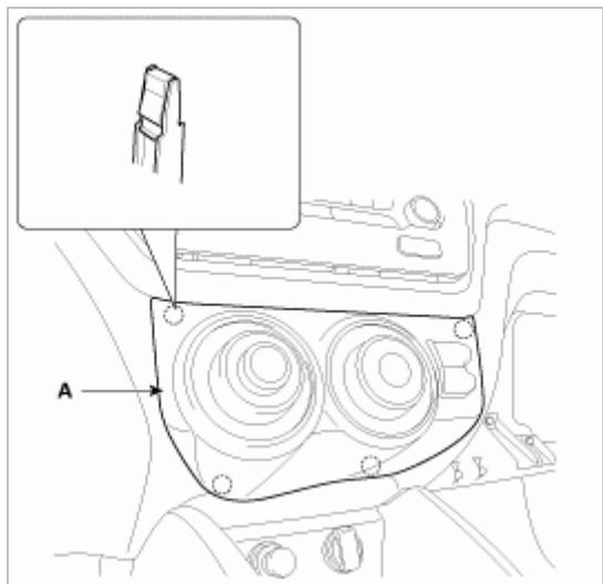
3. 分离3个线束连接器(A)，拆卸暖风和空调控制模块。
